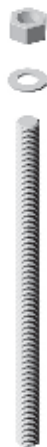
Código AA358-7 Varilla roscada 3/8'' acero SAE 1045 galvanizado con tuerca autofrenante y arandela grover. Para zonas costeras marítimas se aconseja usar varilla de acero inoxidable.
